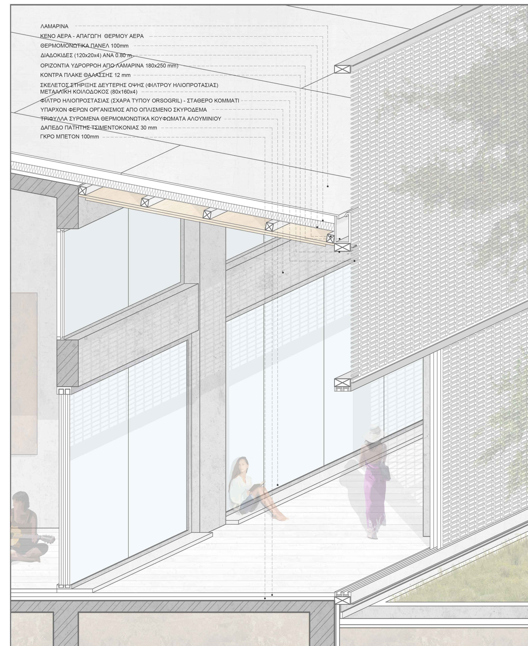
ΚΑΤΑΣΚΕΥΑΣΤΙΚΗ ΛΕΠΤΟΜΕΡΕΙΑ ΦΙΛΤΡΟΥ ΗΛΙΟΠΡΟΣΤΑΣΙΑΣ
